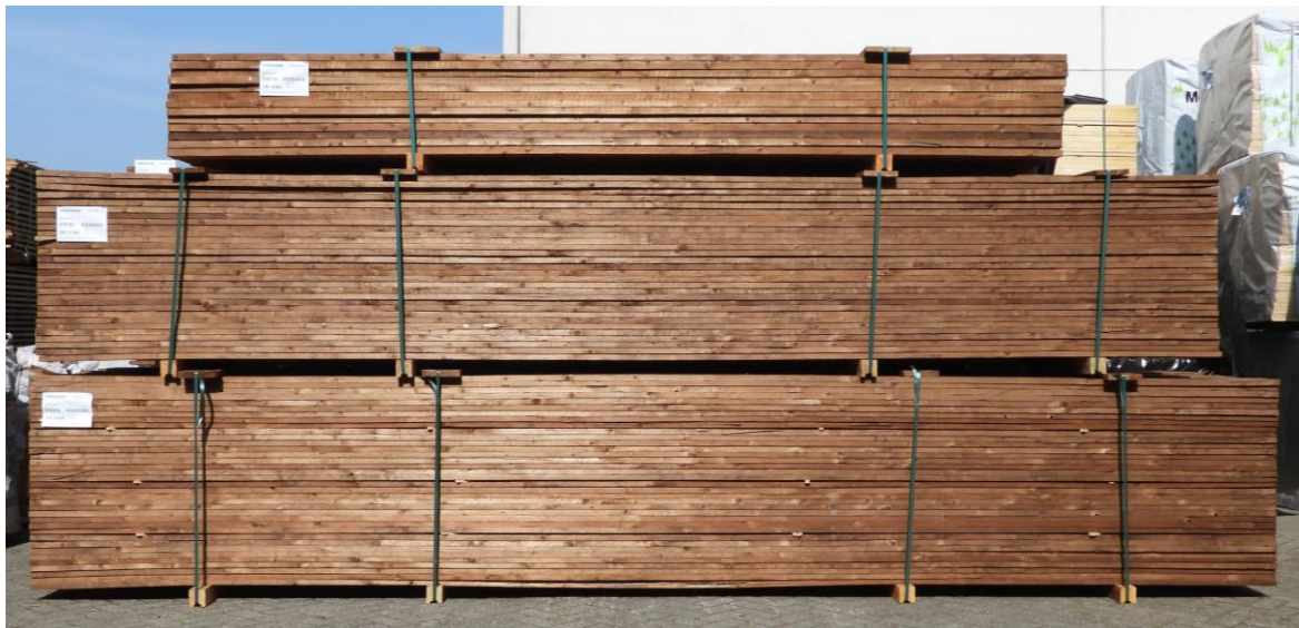
Afbeelding 1 – Onbehandeld hout op de juiste wijze opslaan
